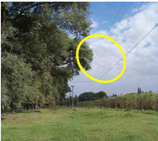
**Figura 5.11.** Arbolado distante de la línea de Media Tensión. Se observa que las ramas llegan a alcanzar a los cables.
