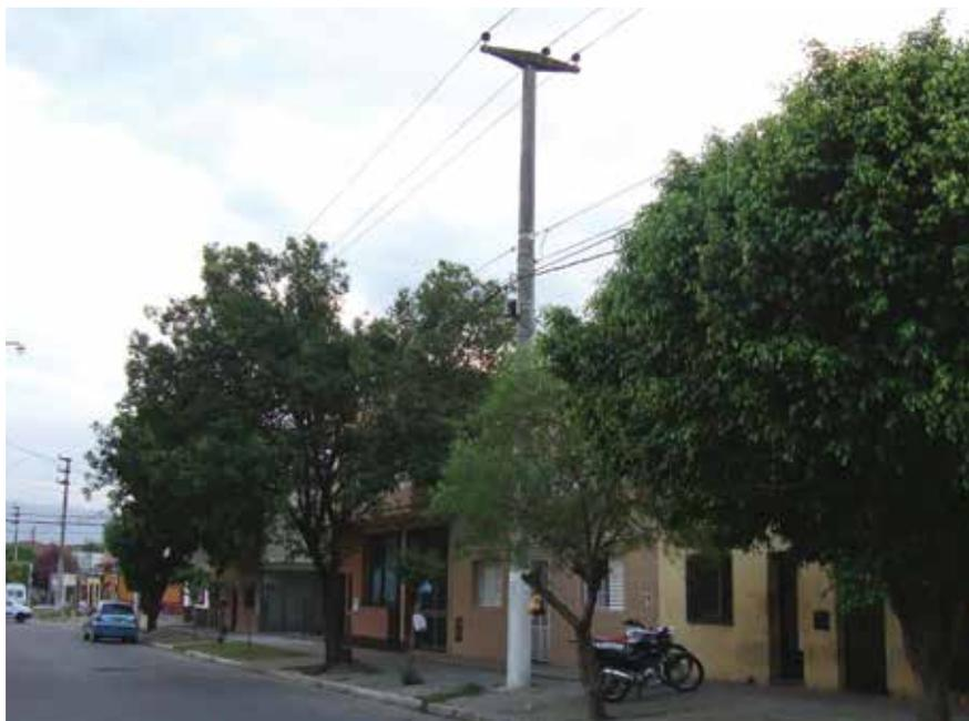
**Figura 5.17.** Líneas de Media Tensión de 13,2 kV convención coplanar horizontal. Se observa intervención en un árbol de mediano porte.
